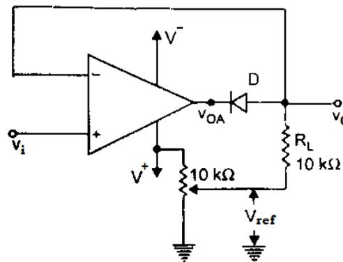
**Fig. 3.44 Positive Clipper Circuit**
