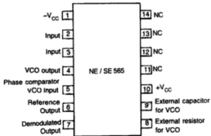
Figure 27(a): Pin Diagram
